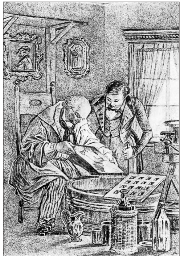
Сцена в гальванопластической мастерской: извлечение клише из ванны. Иллюстрация из книги: Werner F. Ritter der St. Stanislaus Ordens. Die Galvanoplastik in ihrer technischen Anwendung. Mit 12 Kupfertafeln (St.-Petersburg, 1844) [3, ф.187, оп.1, д.11, л.55об].
