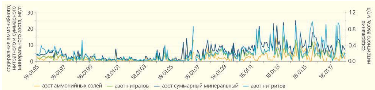
Рис.3. Динамика содержания минеральных форм азота в воде створа «Коломна» Москва-реки в 1995–2018 гг.
